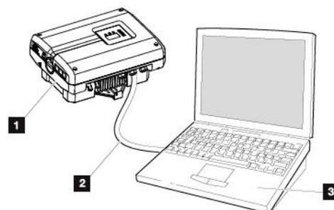
Fig. 52 : Connexion de l'onduleur et de l'ordinateur au moyen d'un câble Ethernet
